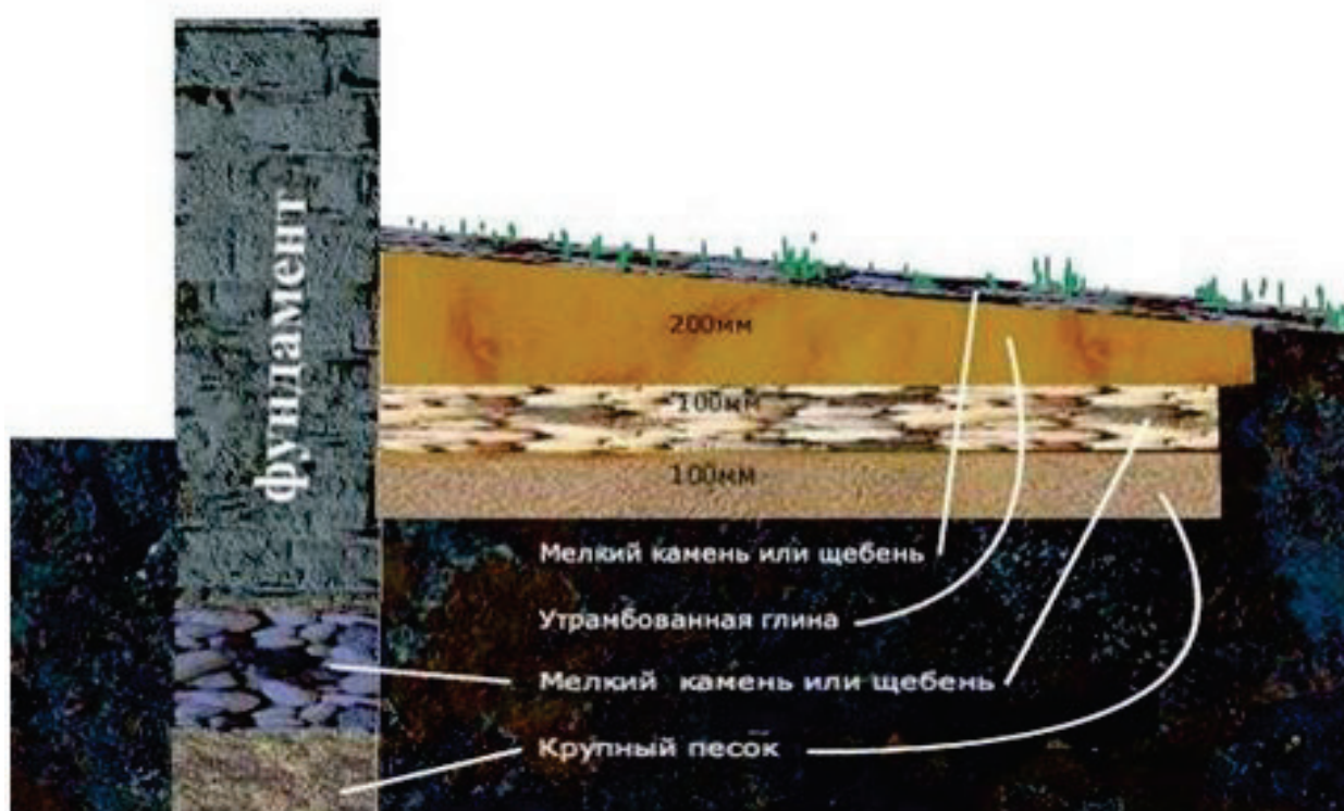
Рисунок 2. - Схема расположение горных пород вокруг фундамента
