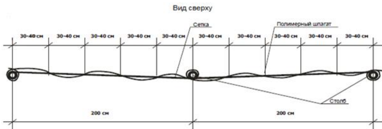
Рисунок 7. Схема установки полимерного шпагата в ограждение
