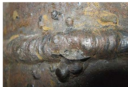
Фотография поры, заполненной газом полость круглой формы
