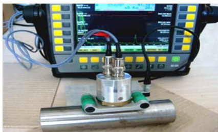
Электромагнитно-акустические преобразователи (ЭМАП)
